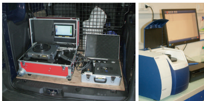
L'analyse NIRS s'effectue en laboratoire et au champ sur des ensileuses.
